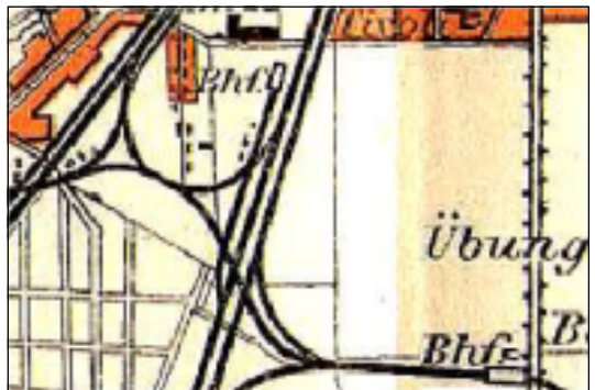
▲ Das Südkreuz an der Berliner Ringbahn um 1894, das aus 2 Teilen besteht – eines am Bhf. Schöneberg und eines am Bhf. General-Papestraße (den es damals noch nicht gab). In Schöneberg existieren zwischen der Wannsee-Bahn (wie wir sie heute nennen) und der Ringbahn in beiden Richtungen Verbindungsgleise – die Cheruskerkurve . Und auch an der Papestraße existierten 3 Verbindungsgleise zwischen der Ringbahn und der Anhaltischen (Vorort-) Bahn. Daß es hier übrigens auch einen „Tivoli“ gab, war dem Autor völlig unbekannt. (Repro: 2007 – khd)
