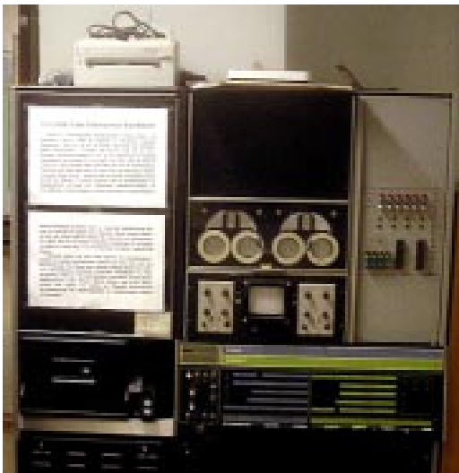
◀ 12-Bit-Prozessrechner LINC-8 der Digital Equipment Corporation (Maynard) von 1966 in Transistor-Technik. Sie war ein Doppel-Computer (LINC und PDP-8) für die neurophysiologische Forschung, von dem nur um die 80 Stück gebaut worden sind. Sie war mit Analog-Eingängen, einem über einen DAC angesteuerten Oszillographen für Grafik-Ausgaben, 2 LINCtape-Laufwerken sowie Lochstreifen-Leser und -Stanzer und einem ASR-33 Teletype ausgestattet. Das Foto stammt vom der Universität Uppsala, wo 2008 an einem Emulations-Projekt gearbeitet wird. (Repro: 2008 – khd)
