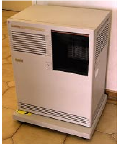
▲ MicroVAX-3500 der Digital Equipment Corporation (Maynard) von 1989 in Chip-Technik mit Ethernet-Anschluß zur Vernetzung. Sie wurde als Server in einem Netzwerk (LAN) von anderen MicroVAXen, PCs und Macs eingesetzt. (Repro: 2008 – khd)
